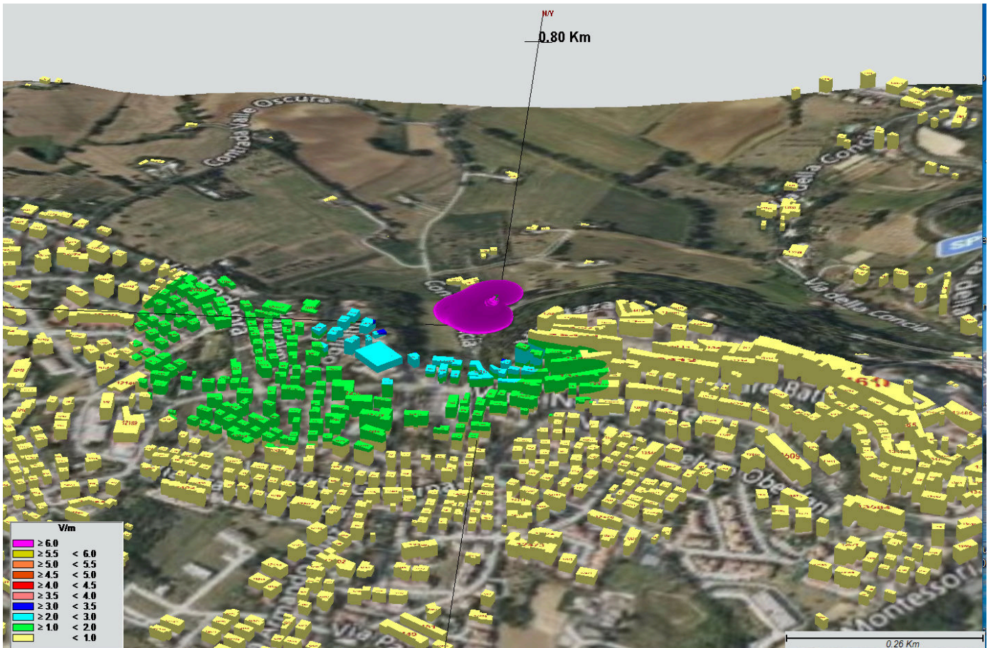
Fig. 7: Impatto EM della SRB posta in Valle Oscura sugli edifici di Castelfidardo Ovest e su Contrada Valle Oscura e via della Conca
