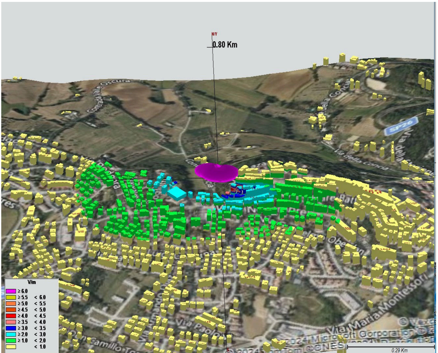
Fig. 6: Impatto EM della SRB posta in Valle Oscura sugli edifici di Castelfidardo Ovest
