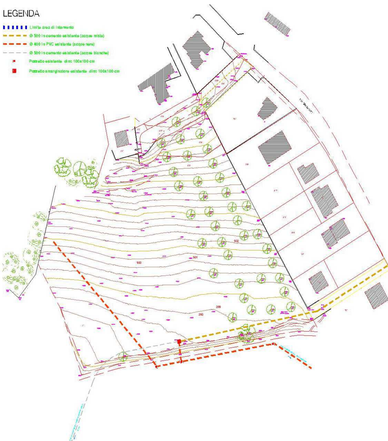
Img. 03 - Stralcio dell'Ortofotocarta con individuazione della linea fognaria esistente.
